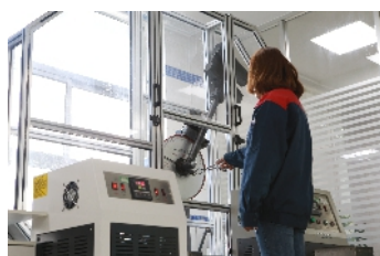
冲击试验 (最低试验温度:-196°C)
